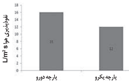
شکل ۱. نفوذپذیری هوای پارچه یکرو و دورو چاپ
